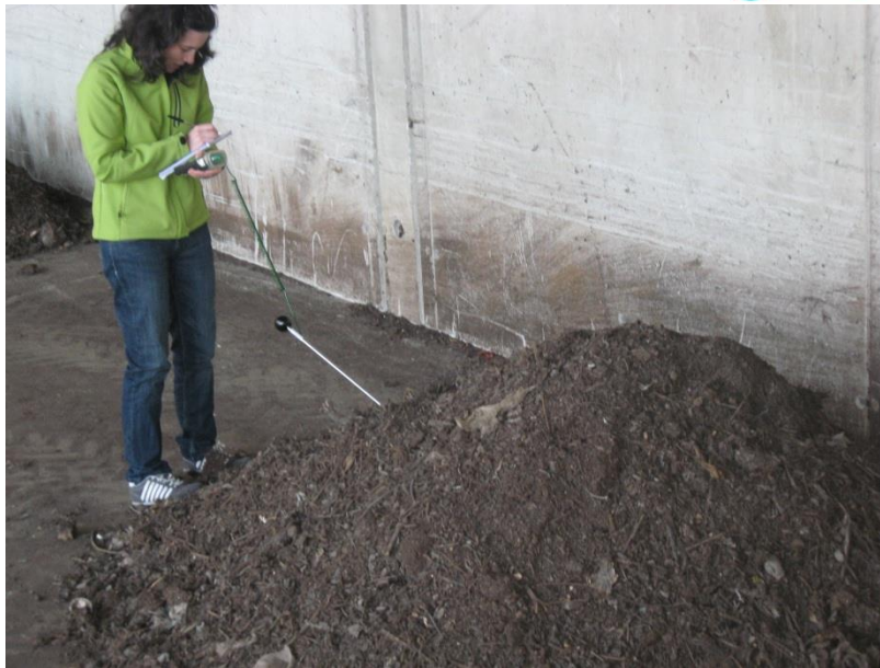
Abbildung 1: Messung der Komposttemperatur
